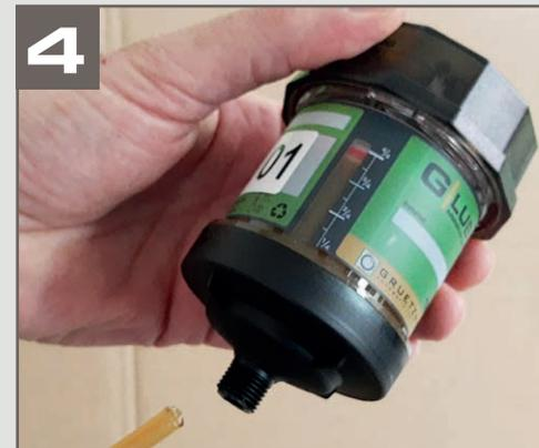
**4** Entfernen Sie den Schlauch vorsichtig und säubern Sie den Auslass. Anschließend kann der Spender an der Schmierstelle aufgeschraubt werden.
