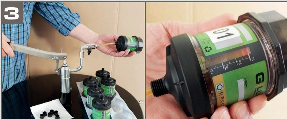
**3** Befüllen Sie G-LUBE. Drehen Sie dabei den Spender um die eigene Achse, um den Schmierstoff optimal zu verteilen. Die Anzahl der Hübe ist abhängig von Spendergröße und Schmierstoff. Sobald ein leichter Gegendruck spürbar ist, ist der Spender vollständig befüllt.
