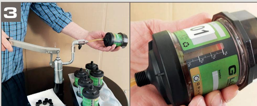
3 Llene el lubricador. Gire el lubricador alrededor de su propio eje para distribuir el lubricante de manera óptima. La cantidad de bombeado dependerá del tamaño del lubricador. En cuanto se siente una ligera contrapresión quiere decir que el lubricador está completamente lleno.
