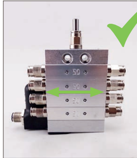
Bild 4: Einbaulage hängend, Kolben horizontal
