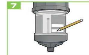
Rotular la etiqueta de lubricador con la fecha de instalación y la fecha programada para la finalización del ciclo de lubricación.
