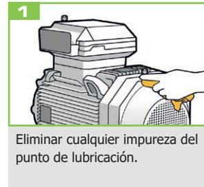
Eliminar cualquier impureza del punto de lubricación.
