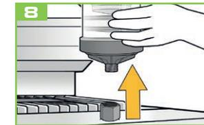
Cuando el periodo de dispensación seleccionado del lubricador haya expirado, retirar el lubricador de la aplicación.
