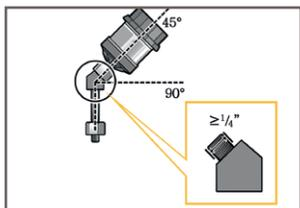
Si el producto se instala en un ángulo de 45° o 90°, utilizar un adaptador angular mayor o igual a 1/4" (diámetro 6-8 mm).
