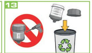
Eliminar el resto de las piezas de plástico de acuerdo con las normas locales de separación de residuos. El lubricador no debe cortarse, perforarse ni reutilizarse.
