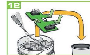
Utilizar un destornillador plano para retirar la placa de circuito impreso del aparato.
