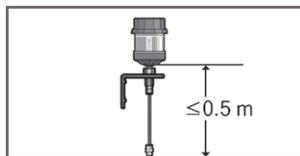
Para el montaje indirecto utilizando una manguera con un diámetro interior de al menos 6 mm, mantener una distancia máxima de 0,5 m.
