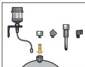
El lubricador está diseñado para la lubricación de un **solo punto**. Siempre será preferible el montaje directo. Para aplicaciones en las que no es posible el montaje directo, montar el aparato indirectamente con los accesorios adecuados y mantener la distancia al punto de lubricación lo más corta posible.
