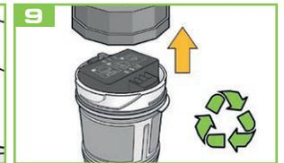
El lubricador es un producto respetuoso con el medio ambiente que debe desecharse por separado. Girar la tapa de la carcasa en sentido contrario a las agujas del reloj para desmontar el aparato con el fin de desecharlo adecuadamente.
