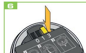
Presionar firmemente el selector del tiempo de dispensación en la ranura del período deseado.
