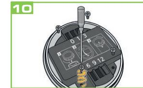
Retirar los tornillos para abrir la tapa de batería.
