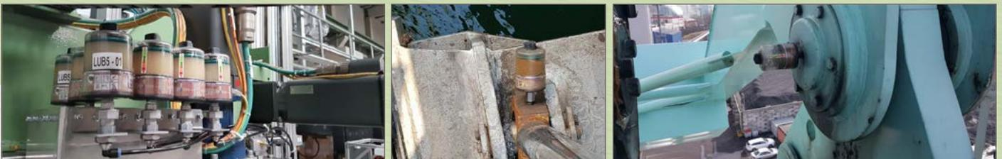
LUB5 ist für eine Vielzahl von Einsatzfällen für die Einzelpunktschmierung konzipiert. LUB5-120 PLUS eignet sich dank der erhöhten Batteriekapazität besonders für den Einsatz bei hohem Gegendruck und tiefen Temperaturen.
