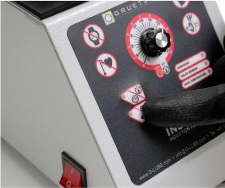
Abb. 14: Anwärmvorgang starten / unterbrechen
