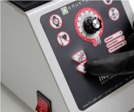
Abb. 11: Anwärmvorgang starten / unterbrechen
