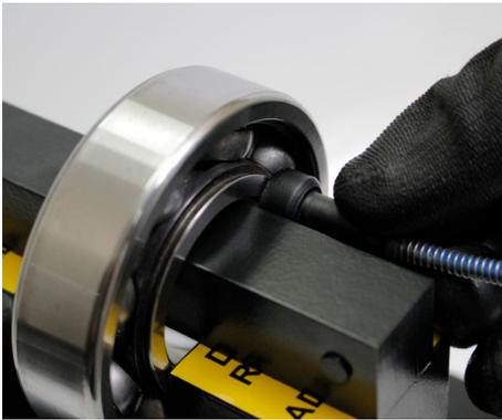
Abb. 8: Temperatursonde befestigen
