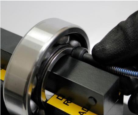
Fig. 8: Fixar a sonda de temperatura
