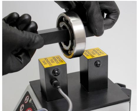
Fig. 6, 7: Colocar o garfo com a peça
