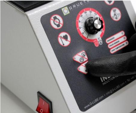
*Fig. 14: Iniciar / interromper o processo de aquecimento*
