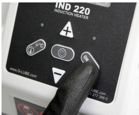
Abb. 18: Anwärmvorgang starten / unterbrechen / Signal beenden
