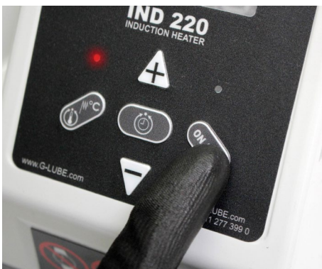
Abb. 13: Anwärmvorgang starten / unterbrechen / beenden
