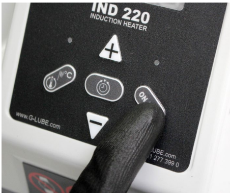
Abb. 22: Anwärmvorgang starten / unterbrechen / Signal beenden
