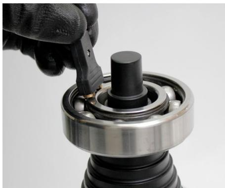
Fig. 7: Fixar a sonda de temperatura
