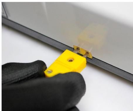
Fig. 8: Inserir a sonda de temperatura
