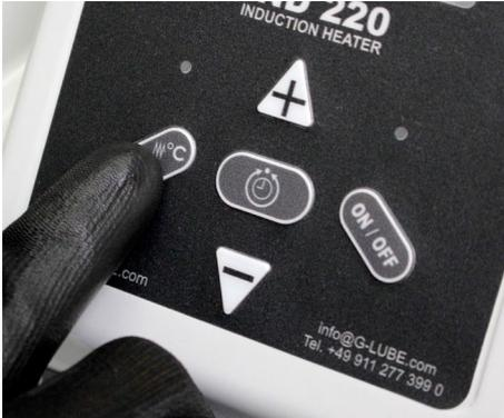
Fig. 14: Função de reaquecimento desativada
