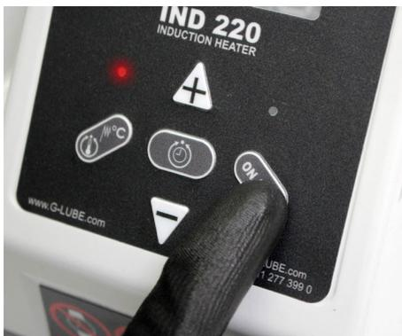
Fig. 13: Iniciar / interromper / terminar o processo de aquecimento
