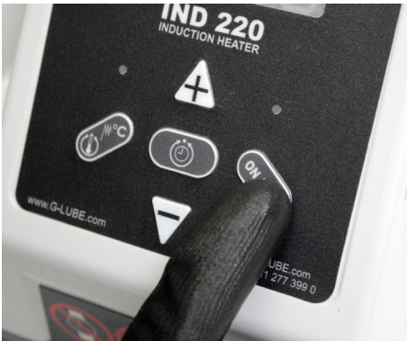
Fig. 22: Iniciar o interrumpir el proceso de calentamiento / detener la señal
