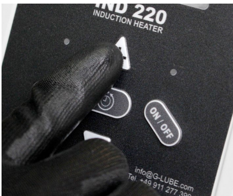
Fig. 20, 21: Ajustar el tiempo de calentamiento
