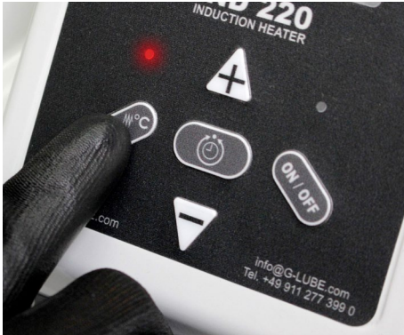
Fig. 9: Función de recalentamiento activada
