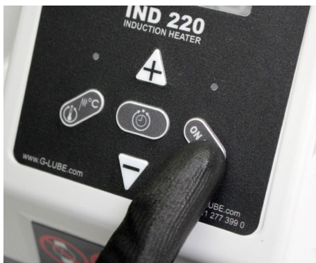
Fig. 18: Iniciar o interrumpir el proceso de calentamiento / detener la señal
