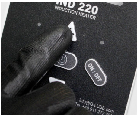
Fig. 15, 16: Ajustar la temperatura
