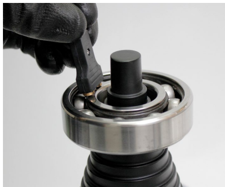
Fig. 7: Fijar el sensor de temperatura
