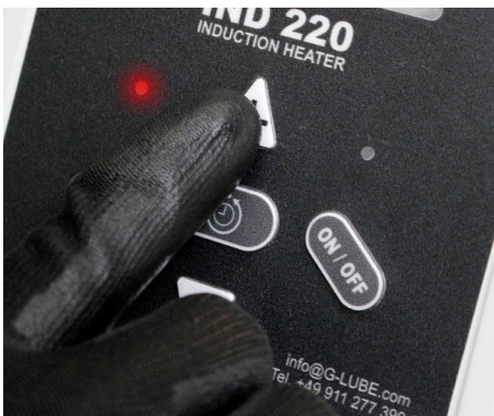
Fig. 10, 11: Ajustar la temperatura
