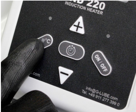
Fig. 14: Función de recalentamiento desactivada
