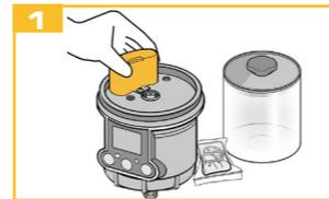
Retire o recipiente do óleo e o velo e instale a bateria. Coloque o velo de volta e aparafuse o tanque de óleo de novo.
