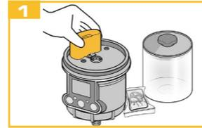
Quite el depósito de aceite y el filtro e introduzca la pila. Vuelva a poner el filtro y enrosque de nuevo el depósito de aceite.
