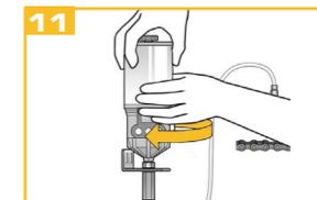
Fije el lubricador en la posición deseada.
