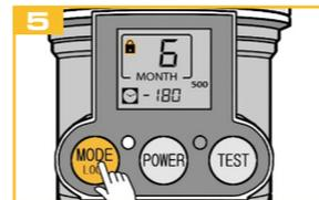
El bloqueo de las teclas se activa una vez pasados 30 segundos. Pulse durante 2 segundos la tecla MODE para desbloquear el dispositivo.
