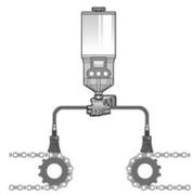
Es posible una instalación con **múltiples puntos** mediante un distribuidor progresivo. No bloquee ninguna conexión del distribuidor progresivo. En su lugar, utilice un distribuidor adecuado en función del número de puntos de lubricación. Mantenga lo más corta posible la distancia entre el distribuidor y la unidad de lubricación.
