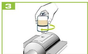
Aparafuse o lubrificador no ponto de lubrificação.
