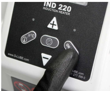
Fig. 18: Iniciar / interromper o processo de aquecimento / terminar o sinal
