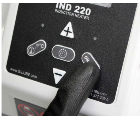
Fig. 22: Iniciar / interromper o processo de aquecimento / terminar o sinal
