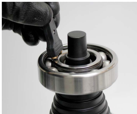
Fig. 7: Fixar a sonda de temperatura
