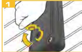
Abra a tampa protetora do sensor de vibração.
