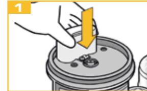
Desaparafuse a parte superior e o cartucho vazio. Troque a bateria e fixe-a com o grampo.
