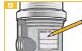
Cole a etiqueta fornecida na unidade de acionamento e registre nela as datas de instalação e de vencimento.
