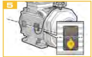
Posicione o sensor de vibração verticalmente com a tampa para baixo.
