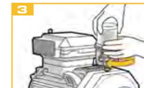
Aparafuse o lubrificador no ponto de lubrificação.
