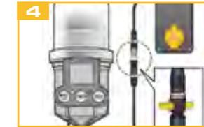
Conecte o cabo conector do lubrificador ao cabo do sensor de vibração.
