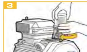
Atornille el lubricador al punto de lubricación.
