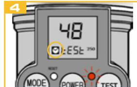
Gire lentamente la rueda en sentido horario hasta que el símbolo de reloj parpadee y el LED rojo se ilumine intermitentemente.
