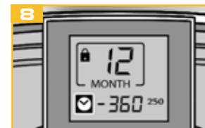
El lubricador está operativo. La pantalla indica sincronización correcta (véase el cap. 5)
