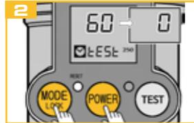
Mantenga presionado POWER y presione MODE para iniciar el modo de detección de vibración. Este proceso dura 60 segundos.
