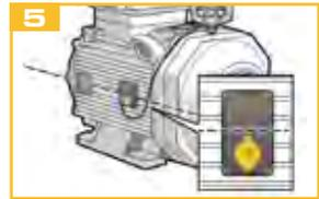
Coloque el sensor de vibración en vertical con la tapa hacia abajo.
