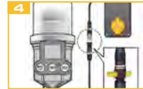
Conecte el cable de conexión del lubricador al cable del sensor de vibración.
