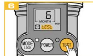
OPÇÃO: pressione a tecla TEST durante 2 segundos para executar um teste de funcionamento. Durante o teste, irá vaziar óleo.
