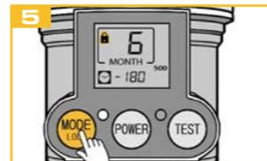
Após 30 segundos, o bloqueio das teclas é ativado. Pressione a tecla MODE durante 2 segundos para desbloquear o aparelho.
