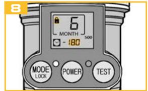
O alimentador de lubrificante está pronto para operação. Após a ativação do bloqueio de teclas, os dias restantes do tempo de execução são exibidos no visor.
