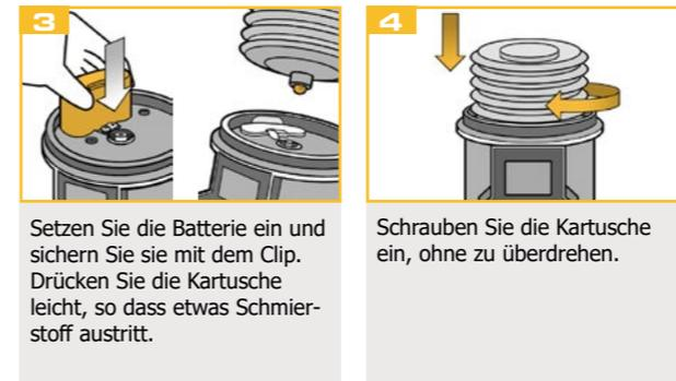
Setzen Sie die Batterie ein und sichern Sie sie mit dem Clip. Drücken Sie die Kartusche leicht, so dass etwas Schmierstoff austritt.
