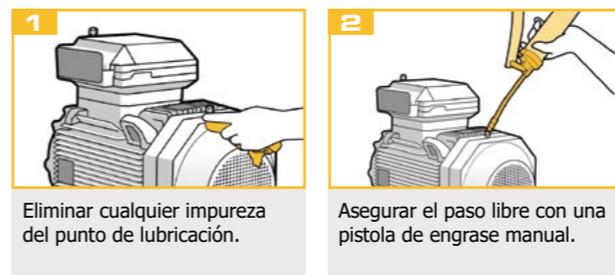
**NOTA** Para asegurar un buen funcionamiento es necesario que los canales de grasa estén continuamente llenos. Debe asegurarse que los canales de grasa no estén obstruidos. Por esta razón, deben lubricarse con una pistola de engrase antes de cada puesta en marcha del dispensador. Eliminar la grasa endurecida enjuagando el punto de lubricación con una pistola de engrase manual. La grasa en el equipo y la grasa contenida en la unidad deben ser iguales o compatibles.
