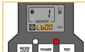
**Pantalla:** Potencia de batería baja (Low battery)
