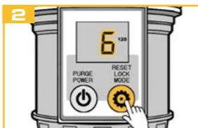
Reponha o dispositivo após a troca do cartucho (ver "5.6 Reposição") e reajuste, em seguida, a quantidade de distribuição.
