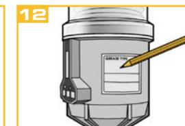
Etiquete a unidade de acionamento com a data de instalação e de vencimento.
