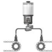
Eine **Mehrpunktinstallation** mittels Progressivverteiler ist möglich. Blockieren Sie keine Anschlüsse des Progressivverteilers. Verwenden Sie stattdessen einen geeigneten Verteiler entsprechend der Anzahl der Schmierpunkte. Halten Sie den Abstand zwischen Verteiler und Schmiereinheit so kurz wie möglich.
