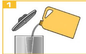
Entfernen Sie den Deckel des Ölbehälters und füllen Sie ihn bis zum Füllstand 480 ml mit Öl auf.
