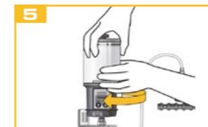
Fije el lubricador en la posición deseada.
