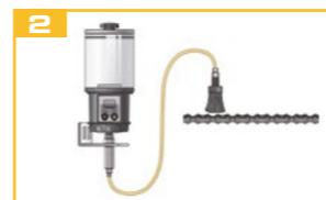
Si el lubricador está instalado debajo del punto de lubricación, asegúrese de que los conductos de lubricación estén llenos.
