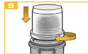
Aparafuse a parte superior na unidade de acionamento. A parte superior encaixa com um clique audível.
