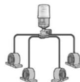
É possível realizar uma **instalação multipontos** por meio do distribuidor progressivo. Não bloqueie nenhuma conexão do distribuidor progressivo. Em vez disso, utilize um distribuidor progressivo adequado de acordo com o número de pontos de lubrificação. Mantenha a menor distância possível entre o distribuidor e a unidade de lubrificação.
