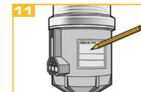
Etiquete a unidade de acionamento com a data de instalação e de vencimento.
