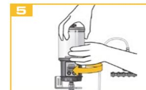
Encaixe o alimentador de lubrificante na posição desejada.
