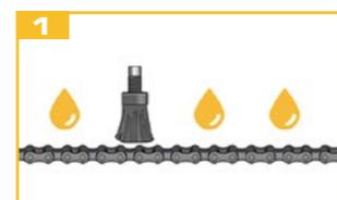
Antes de ativar o alimentador de lubrificante, certifique-se de que a aplicação esteja completamente pré-lubrificada.
