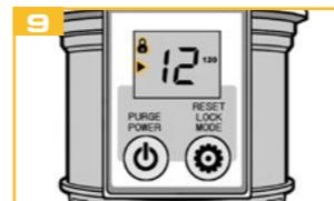
Espere 7 segundos. Ahora el bloqueo de teclas está activado y el lubricador operativo ( y ) se muestran en la visualización digital).
