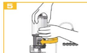
Fije el lubricador en la posición deseada.
