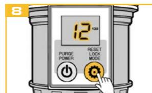
Mientras parpadea la indicación del mes, pulse las veces necesarias hasta que se muestre el tiempo de dispensación en la visualización digital.
