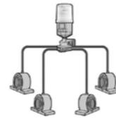
Es posible una instalación con **múltiples puntos** mediante un distribuidor progresivo. No bloquee ninguna conexión del distribuidor progresivo. En su lugar, utilice un distribuidor adecuado en función del número de puntos de lubricación. Mantenga lo más corta posible la distancia entre el distribuidor y la unidad de lubricación.
