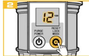
Reinicie el aparato después del relleno (véase «5.6 Reset») y a continuación reajuste la cantidad de dispensación.
