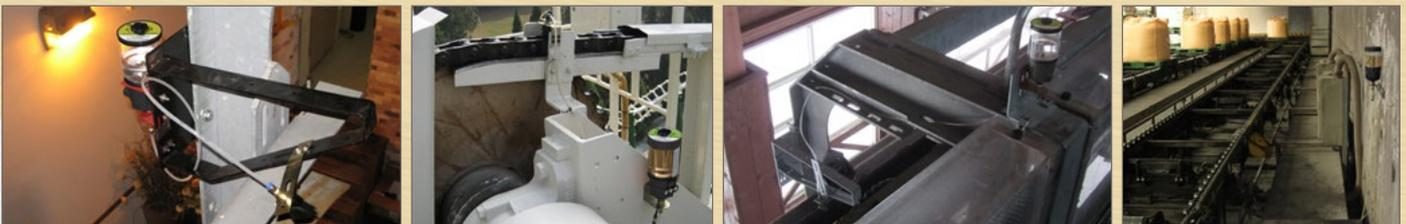
Mit bis zu 10 bar Förderdruck ermöglichen G-LUBE EM V OIL und G-LUBE EM D OIL Schmierung über größere Distanzen und Mehrpunktschmierung. Durch die Synchronisierung mit der Maschinenlaufzeit oder die direkte Ansteuerung via SPS ist präzise, bedarfsgerechte Schmierung garantiert.
