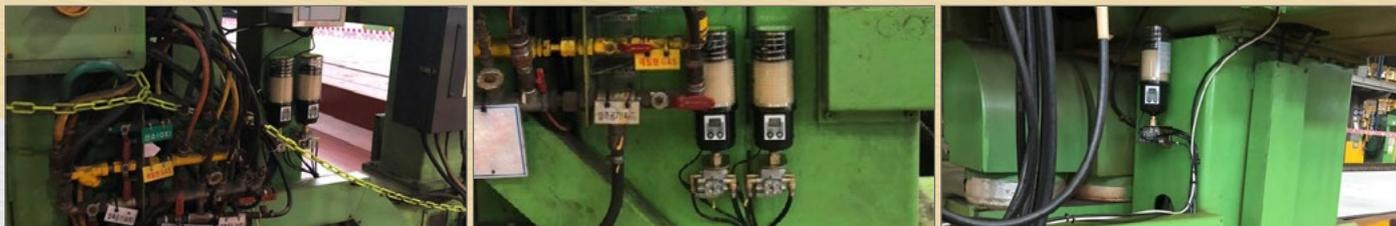
Com uma tensão de funcionamento de 9-36 VCC, o G-LUBE EM V pode ser utilizado de forma flexível. A sincronização com o tempo de execução da máquina garante uma lubrificação exata e baseada nas necessidades. A utilização sem bateria reduz os custos subsequentes e protege o ambiente.
