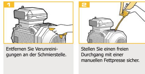
Entfernen Sie Verunreinigungen an der Schmierstelle.
