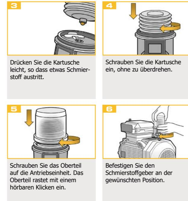
Drücken Sie die Kartusche leicht, so dass etwas Schmierstoff austritt.
