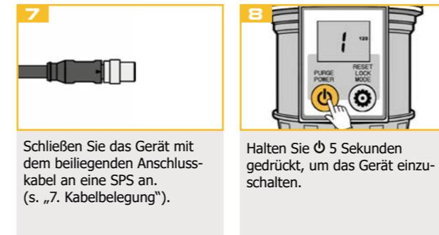
Schließen Sie das Gerät mit dem beiliegenden Anschlusskabel an eine SPS an. (s. „7. Kabelbelegung“).
