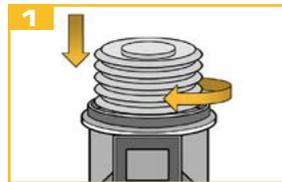
Schrauben Sie das Oberteil und die leere Kartusche ab. Wechseln Sie die Kartusche.
