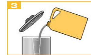
Entfernen Sie den Deckel des Ölbehälters und füllen Sie ihn bis zum Füllstand 480 ml mit Öl auf.
