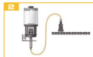
Wenn der Schmierstoffgeber unterhalb der Schmierstelle installiert wird, stellen Sie sicher, dass die Schmierleitungen befüllt sind.
