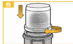
Enrosque la parte superior en la unidad de accionamiento. La parte superior encaja con un clic audible.
