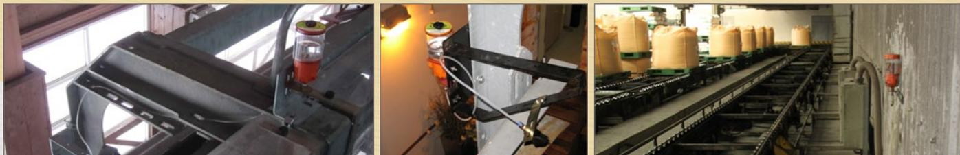
Como sistema de lubrificação a óleo operado por bateria, o G-LUBE EM B OIL é autossuficiente e, portanto, particularmente flexível. Com uma pressão de alimentação de até 10 bar, a lubrificação também é possível em distâncias maiores.
