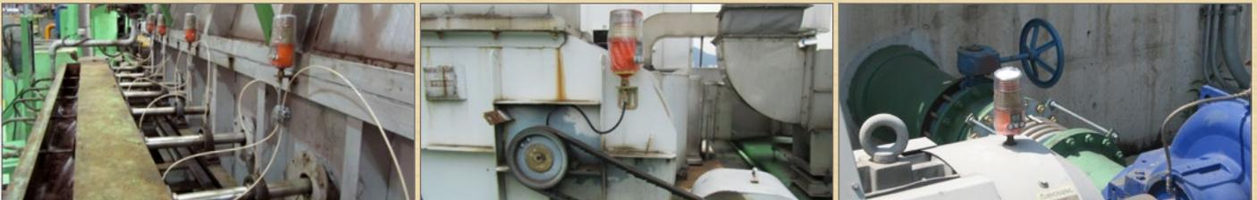
G-LUBE EM B sorgt bis zu 12 Monate lang für präzise Schmierung und ist durch den Batteriebetrieb völlig autark. Dank des hohen Betriebsdrucks kann das System bei Bedarf auch für mehrere Schmierstellen verwendet werden.
