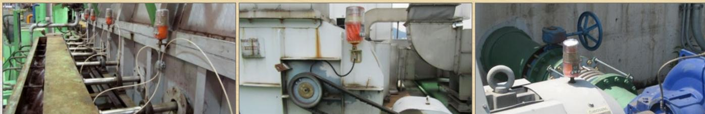
G-LUBE EM B proporciona una lubricación precisa durante hasta 12 meses y es completamente autárquico gracias a su funcionamiento con batería. Gracias a su elevada presión de servicio, el sistema también se puede utilizar para múltiples puntos de lubricación si es necesario.
