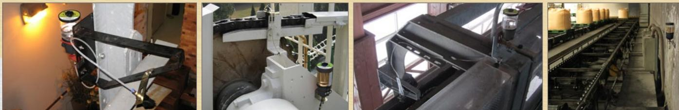
Com uma pressão de saída de até 10 bar, o G-LUBE EM V OIL e o G-LUBE EM D OIL permitem a lubrificação em longas distâncias e a lubrificação multipontos. A sincronização com o tempo de execução da máquina ou com o acionamento direto via PLC garante uma lubrificação exata e baseada nas necessidades.
