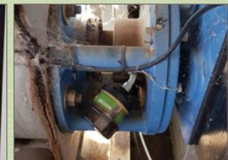
G-LUBE se puede utilizar en casi todos los sectores industriales, el lubricador se activa de manera simple y sin herramientas. Para la instalación indirecta, recomendamos el uso de nuestros accesorios.
