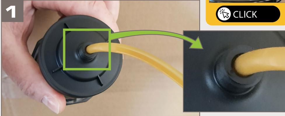
**1** Führen Sie einen Schlauch mit einem Außendurchmesser von max. 6 mm so weit wie möglich in die Öffnung an der Unterseite von G-LUBE ein. Ein größerer Schlauch würde das Entweichen der Luft beim Einfüllen des Schmierstoffs verhindern.
