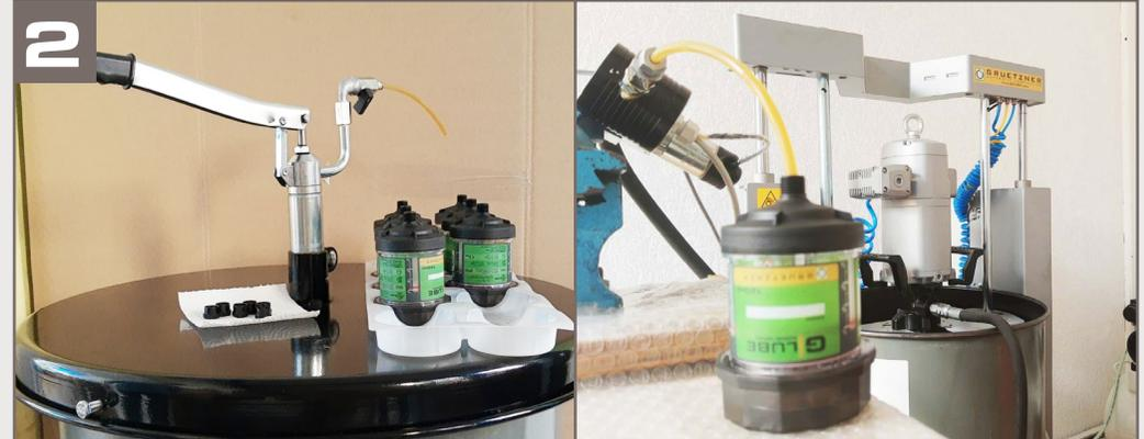
**2** Schließen Sie an das Schlauchende eine Handhebelpresse oder eine Hobbock-Pumpe an.
