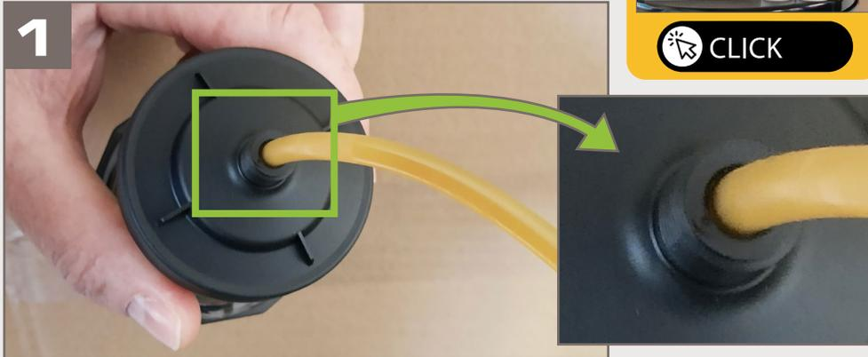
1 Insertar al máximo posible una manguera con un diámetro exterior de máx. 6 mm en la abertura situada en la parte inferior del G-LUBE. Una manguera más grande no permitiría que el aire salga al introducir lubricante.
