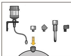
O lubrificador foi projetado apenas para lubrificação de **ponto único**. A montagem direta é sempre preferível. Para aplicações que não permitem montagem direta, instale o dispositivo indiretamente com os acessórios apropriados e mantenha a distância mais curta possível até o ponto de lubrificação. Para instalação indireta, use uma mangueira com pelo menos 6 mm de diâmetro interno, pré-cheia com a mesma graxa (ou compatível) contida na unidade.
