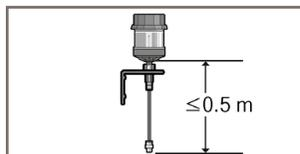
Para montagem indireta usando uma mangueira com um diâmetro interno mínimo de 6 mm, mantenha uma distância máxima de 0,5 m.
