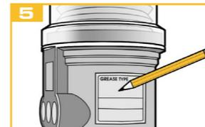
Pegue la etiqueta adjunta en el accionamiento y rotulela con la fecha de instalación y expiración.
