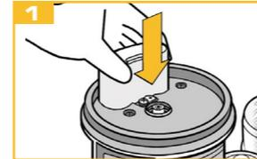
Desrosque la pieza superior y el cartucho vacío. Cambie la batería y asegúrela con el clip.
