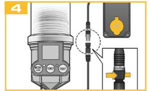
Conecte el cable de conexión del lubricador al cable del sensor de vibración.
