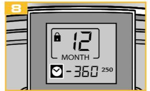
El lubricador está operativo. La pantalla indica sincronización correcta (véase el cap. 5).
