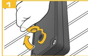
Abra la tapa de protección del sensor de vibración.
